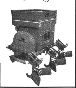
Vielfachgeräte: Federzinkenhackgruppe mit grossen Zudeckscheiben zum Nachhäufeln vor dem Versiegeln der Kartoffeln oder Häufelkörpern und Kammjätern zum mehrmaligen Bearbeiten der Kartoffeldämme bei mechanischer Unkrautbekämpfung. Auch für Mais, Rüben usw. bestens geeignet. MÜLLER-Vielfachgeräte sind seit Jahren ein Qualitätsbegriff!
