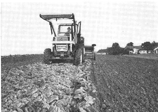
Abb. 3: Das Arbeitsbild der Kreiselegge in Kombination mit der Sämaschine nach einer Pflugfurche.
