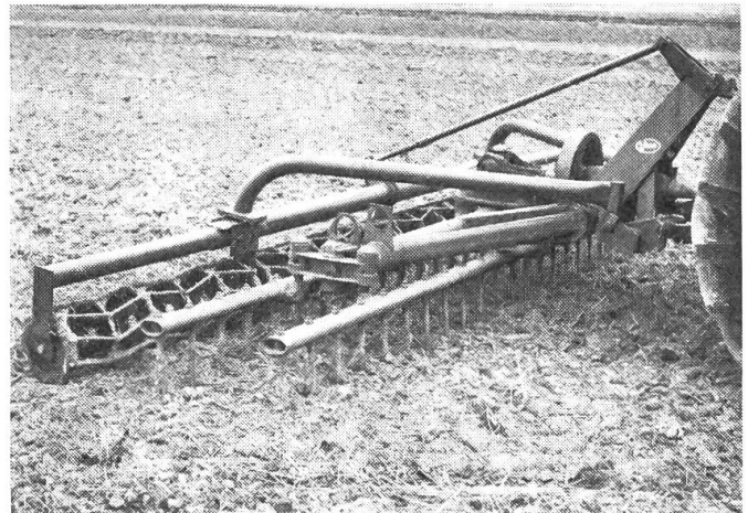
Abb. 1: Die Pendelegge mit angelenkter Stabkrümelwalze.
