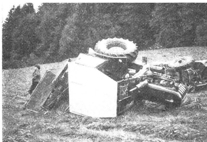
Abb. 3: Je breiter das Sicherheitsverdeck ist, desto mehr hindert es den Traktor am Ueberrollen.
