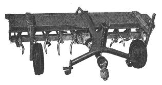
Rotor-Spaten oder Zinken-Egge für ganz besondere Leistungen durch die patentierte runde Zinkenform. Unvergleichliche Eggarbeit. Kein zerschneiden des Unkrautes. Keine Sohlenbildung des Untergrundes. Nachstellbare, verschleissarme Zinken.
