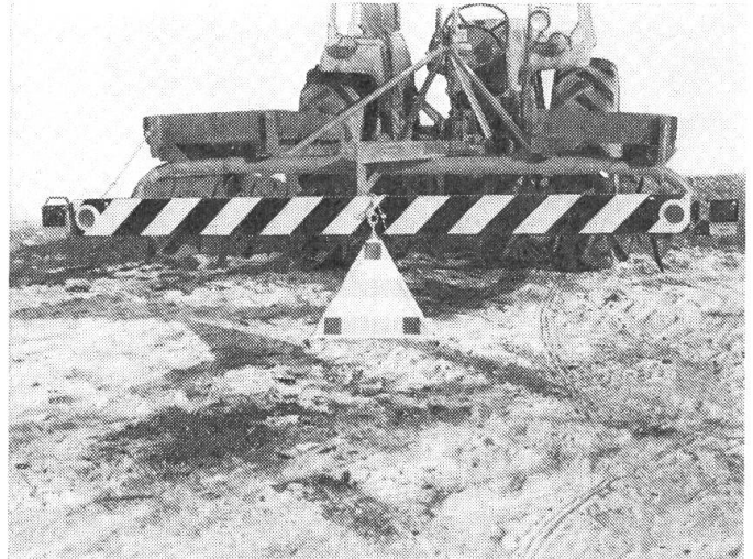
Abb. 1d: Spatenegge mit Signalisations- und Schutzbrett.
