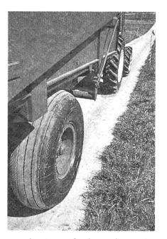
Die schweren Lasten erfordern eine entsprechende tragfähige Bereifung. Eine häufige Kontrolle des Luftdruckes drängt sich deshalb auf.
