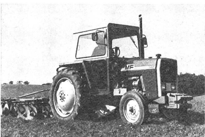
schützter, bequemer, sicherer und damit vorbildlicher Arbeitsplatz geboten. Alle Traktoren der 500er Reihe sind serienmäßig mit einer hydrostatischen Lenkung und Synchrogetriebe ausgerüstet. Der Komfortsitz ist gut gefedert und nach Körpergrösse und Gewicht verstellbar. Neue, hängende Pedale für Kupplung und Bremsen entsprechen beim Betätigen dem natürlichen Bewegungsablauf der Beine und lassen sich daher leichter bedienen.
