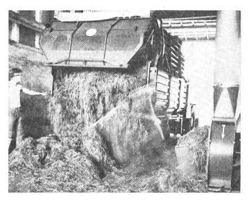
Abb. 2: Schnellentladung für Welkheu. Das stark vorgeschnittene Futter lässt sich bedeutend besser weiter fördern.
