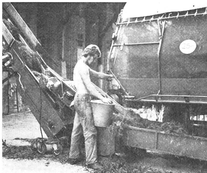
Abb. 4: Ganz allein bedient der Traktorfahrer den Kratzbodenvorschub und streut noch gleichzeitig das Silierhilfsmittel ein. Die Auflösewalzen beliefern das Förderband dank dem sechsstufigem Kratzpostvorschub sehr gleichmässig.
