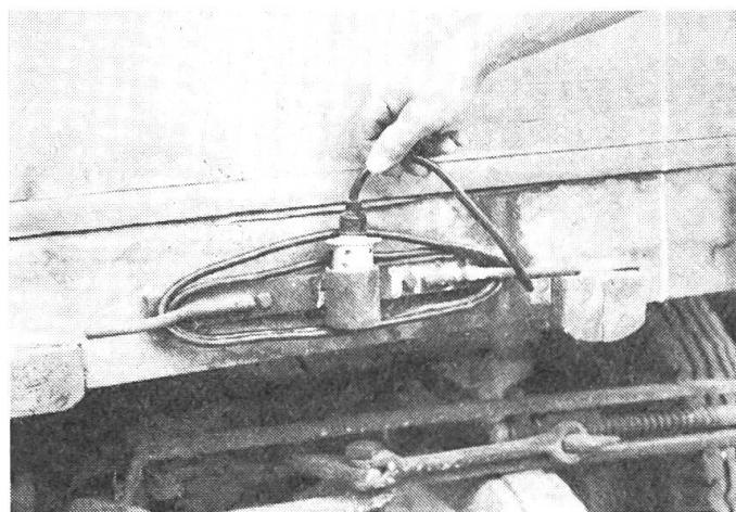
In Abb. 1 wird gezeigt, wie man durch eine einfache Vorrichtung einen Stecker vor Korrosion oder Verschmutzung und das Kabel vor Verklemmung durch die Zugdeichsel schützen kann.
