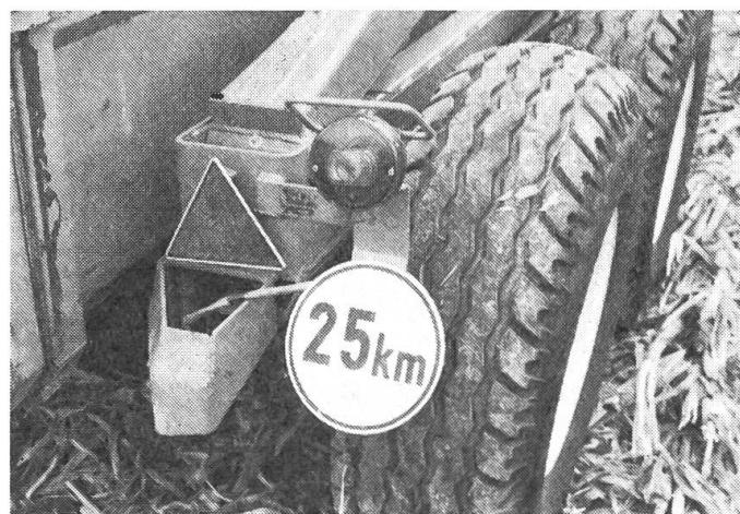
Abb. 2 und 3 demonstrieren einfache Lösungen zum Schutze der leicht verschleißbaren Leuchtengläser. Es empfiehlt sich, beim Kauf der Leuchten auf solche vermeintlichen Kleinigkeiten zu achten. Sie helfen viele Unannehmlichkeiten und Ärgernisse zu verhüten.
