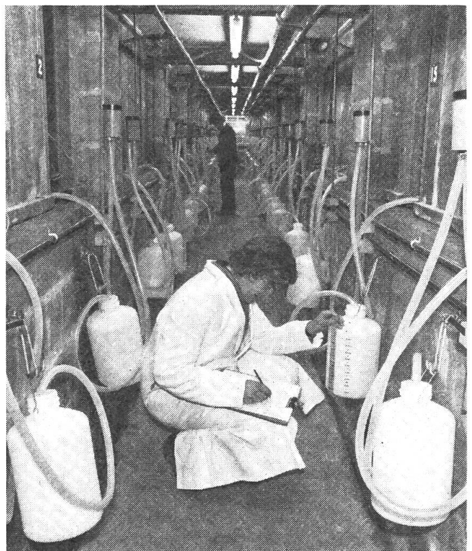
Abb. 2: Blick in den unterirdischen Raum mit den Mess- und Wasserstandsregler-Geräten.
