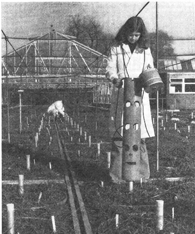
Abb. 1: Gut erkennbar ist das Anordnen der Versuche in wasserdichten Schalen und die Möglichkeit der Durchführung der notwendigen Messungen.
