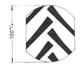
auf allen Bodenarten erzielen. Continental hat beispielsweise mit diesem AS-Treibrad-Radial-Reifen bei mehreren Messungen Zugkraftverbesserungen von etwa 25% und mehr ermittelt (Abb. 4).
