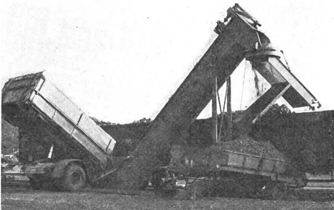
Abb. 1: Entleerung ab Traktoranhänger mit Kratzboden in den versenkten Sammeltrichter. Rechts im Bild sind die Absonderung der Fremdkörper durch den Stabrost und der Verlad in den Bahnwagen gut sichtbar. Man beachte das Sammeln der Verunreinigungen (Erde, Steine, Kraut) in den darunterstehenden Anhänger.
