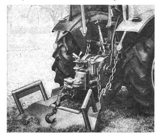
Eine Reihe Modelle von 3 bis 7 t Zugkraft, für Traktoren von 35 bis 100 PS, mit breitem oder schmalem Verankerungsschild. Spezialseilwinden, Forstseilwinden, Doppeltrommelseilwinden. Gerne senden wir Ihnen detaillierte Unterlagen.
