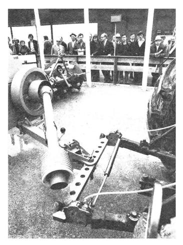
Abb. 2: Auch über die Ackerschiene, die nur geringfügig umgebaut zu werden braucht, können die Anhängegeräte — wie hier die Hochdruck-Ballenpresse — mit der WKS-Dreipunktkupplung in Einmannarbeit vom Traktorsitz aus an- und abgekoppelt werden.
