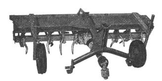
Rotor-Spaten oder Zinken-Egge für ganz besondere Leistungen durch die patentierte runde Zinkenform. Unvergleichliche Eggarbeit. Kein zerschneiden des Unkrautes. Keine Sohlenbildung des Untergrundes. Nachstellbare, verschleissarme Zinken.
