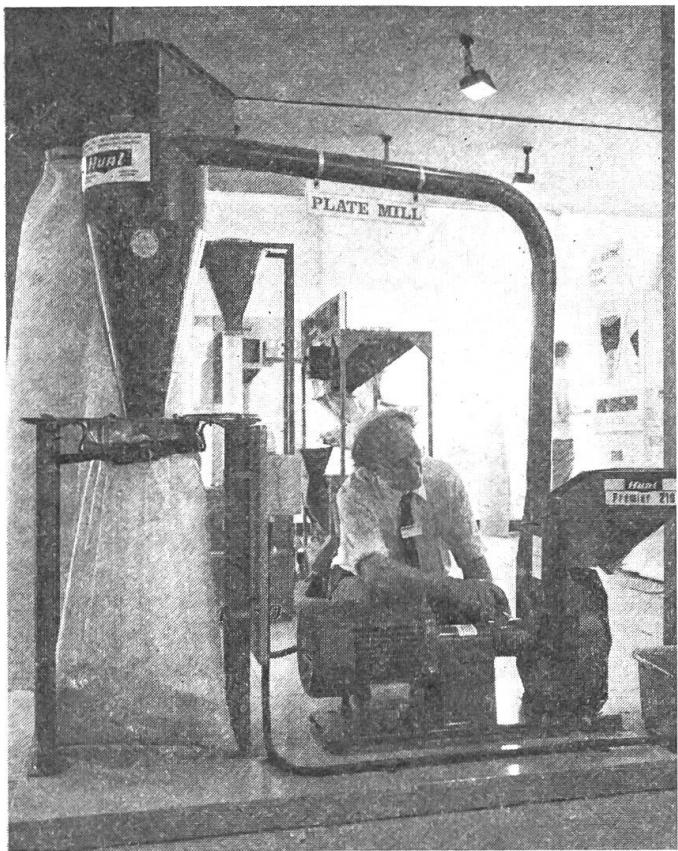
entfernt, der oben auf dem «Zyklon» angeschraubt ist. Dieser scheidet das Mehl aus dem Luftstrom ab und führt es in aufgehängte Säcke ein (links). Die raumsparende Maschine lässt sich bequem in eine neue oder bestehende Anlage einordnen.
