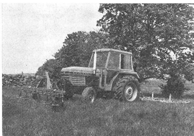
Die als «Uni-Link» bezeichnete Ausrüstung lässt sich an allen handelsüblichen Traktoren wie diesem 55-PS-Modell von British Leyland ohne Modifikationen anbauen, da sie einfach an Stelle des Ballastgewichtrahmens tritt.
