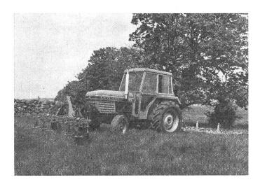
Die als «Uni-Link» bezeichnete Ausrüstung lässt sich an allen handelsüblichen Traktoren wie diesem 55-PS-Modell von British Leyland ohne Modifikationen anbauen, da sie einfach an Stelle des Ballastgewichtrahmens tritt.
