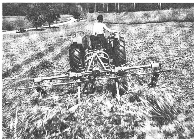
Abb. 2: AEBI-FELLA-Turboheuer, 3,80 m, mit beweglichem Dreipunktbock.
