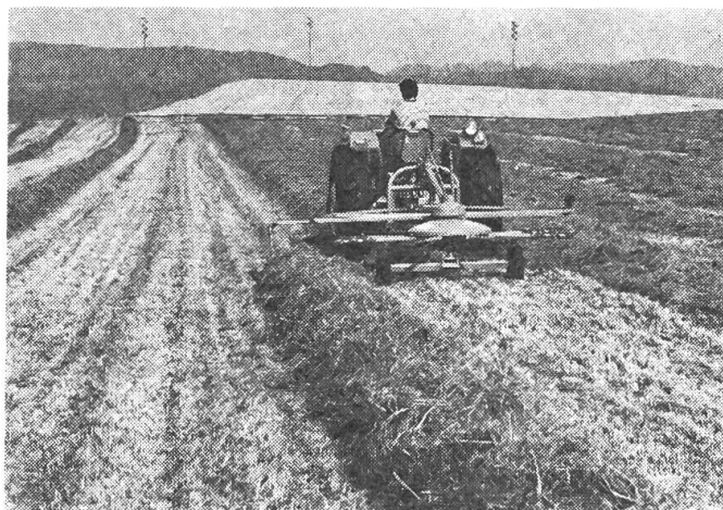
Abb. 3: AEBI-FELLA-Turboschwader, 2,80 m, mit beweglichem Dreipunktbock.
