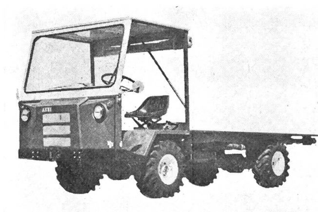
Abb. 4: AEBI-Transporter TP 35, 33 DIN-PS, Nutzlast 2200 kg.
