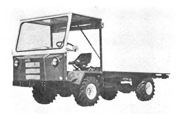
Abb. 4: AEBI-Transporter TP 35, 33 DIN-PS, Nutzlast 2200 kg.
