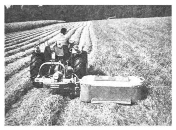
Abb. 1: AEBI-FELLA-Kreiselmäher, 1,8 m, mit Schnitthöhen-Schnellverstellung.
