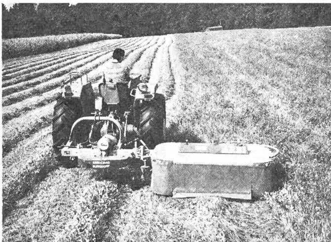
Abb. 1: AEBI-FELLA-Kreiselmäher, 1,8 m, mit Schnitthöhen-Schnellverstellung.
