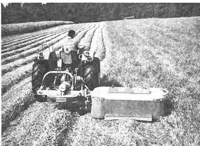
Abb. 1: AEBI-FELLA-Kreiselmäher, 1,8 m, mit Schnitthöhen-Schnellverstellung.
