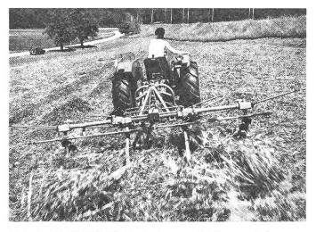
Abb. 2: AEBI-FELLA-Turboheuer, 3,80 m, mit beweglichem Dreipunktbock.
