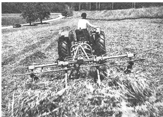
Abb. 2: AEBI-FELLA-Turboheuer, 3,80 m, mit beweglichem Dreipunktbock.
