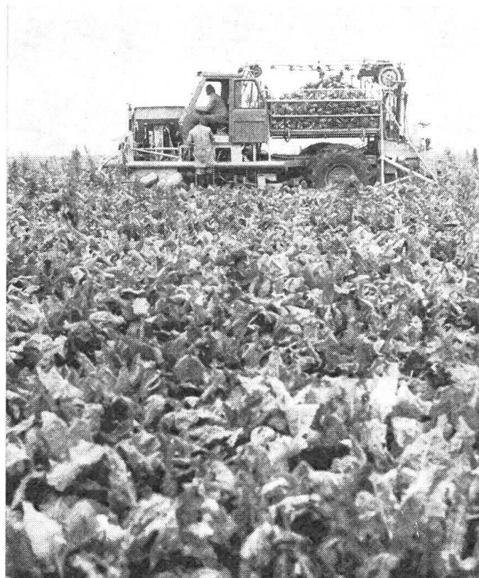
Die selbstfahrenden zwei- und dreireihigen Bunkerköpfroder haben den Vorteil, dass die Rüben, in der Gare gerodet, gleich bis ans Feldende mitgenommen werden. Wegen der zumeist kleinen Rübenflächen je Betrieb muss der Einsatz der mehrreihigen Selbstfahrer meist überbetrieblich organisiert werden.
