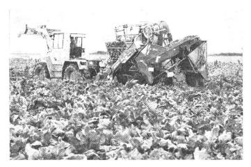
Noch immer wird die Mehrzahl der Zuckerrüben mit dem gezogenen Bunkerköpfroder geerntet, der auch zweireihig angeboten wird. Während die Rüben bis ans Feldende mitgenommen werden, kann das Rübenblatt — lang oder gehäckselt — aufs Feld abgelegt oder im Bunker zum Schlagende transportiert werden.
