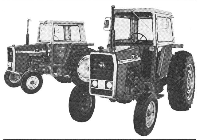
MF-560 Supercab-Traktor 56 DIN/PS bei 2000 U/min. MF-575 Supercab-Traktor 66 DIN/PS bei 2000 U/min. MF-590 Supercab-Traktor 75 DIN/PS bei 2200 U/min. MF-595 Supercab-Traktor 88 DIN/PS bei 2000 U/min.
