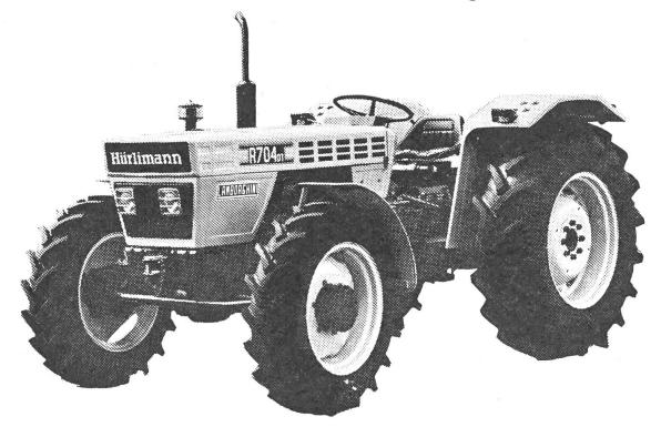
Typen mit 47, 56, 70 DIN-PS, vor allem mit Allradantrieb.
