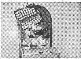
Sellerieputzmaschine System E, rationell, grosse Kapazität, einfach. arbeitet im Durchlaufverfahren, trocken oder mit Sprühanlage. Antrieb durch Elektromotor.
