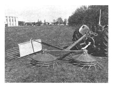
2 Rotoren, welche das Futter in einer Durchfahrt über eine Breite von 3,6 m auf einen Schwad legt. Diese Maschine hat die gleichen Eigenschaften wie der Kombiheuer HS 360, kann aber nur schwaden, dies aber mit einer Fahrgeschwindigkeit bis 12 km/h. Fachleute prophezeien diesen beiden Geräten einen grossen Erfolg.
