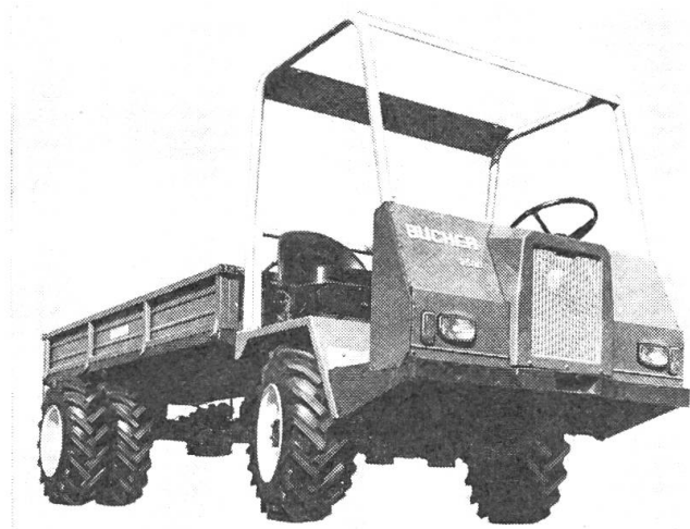
BUCHER-Transporter TR 2500, Nutzlast 2500 kg. Der Sicherheitsrahmen kann nach dem Baukastensystem zum Sicherheitsverdeck und zur Sicherheitskabine verwandelt werden.
