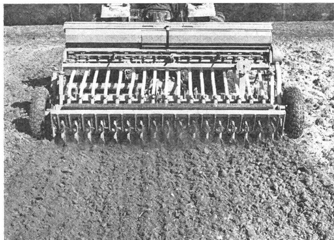
Erfreulich zu hören ist, dass keine langen Rüstzeiten erforderlich sind, auch ist ein Verstopfen durch Erdbrocken nicht möglich. Die Saat erfolgt direkt hinter dem Rotor in die noch fliessende Erde, so dass eine gute Kornverteilung erreicht wird. Die Einstellung der Saattiefe erfolgt durch Verschwenken der Bandsävorrichtung. Das Gerät hat eine Arbeitsbreite von 2,55 m und erfordert Traktoren um die 100 PS.
