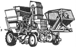
Zuckerrüben-Vollernter, gezogen und selbstfahrend
