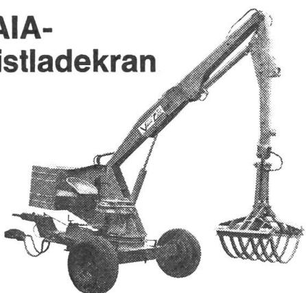
5-m-Auslegearm und Mistgabel, vollhydraulisch, Bereifung 10 x 15, mit grosser Hydraulikpumpe, an Zapfwelle oder mit Gelenkwelle, Diesel- oder Elektromotor. Jede Maschine kann auch mit Tieflöffel oder Greifer ausgerüstet werden
