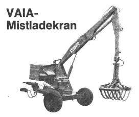
5-m-Auslegearm und Mistgabel, vollhydraulisch, Bereifung 10 x 15, mit grosser Hydraulik-Pumpe, an Zapfwelle oder mit Gelenkwelle, Diesel- oder Elektromotor. Jede Maschine kann auch mit Tieflöffel oder Greifer ausgerüstet werden
