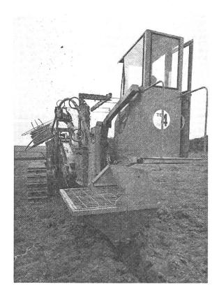
Arbeiten am Hang und (eine Wohltat für den Fahrer) die luftgekühlte Steuerkabine kann hydraulisch gehoben und gesenkt werden, was Ein- und Austritt weitgehend erleichtert. Der Antrieb des TG4 erfolgt von einem 202 Sechszylinder-Dieselmotor mit Wasserkühlung.
