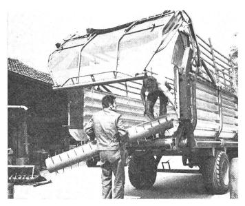
Abb. 3: Für Silofutter werden Auflösewalzen eingesetzt und das Silierschneidwerk eingeschwenkt.
