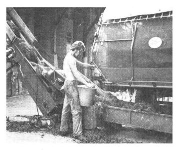
Abb. 4: Ganz allein bedient der Traktorfahrer den Kratzbodenvorschub und streut noch gleichzeitig das Silierhilfsmittel ein. Die Auflösewalzen beliefern das Förderband dank dem sechsstufigem Kratzpostvorschub sehr gleichmässig.
