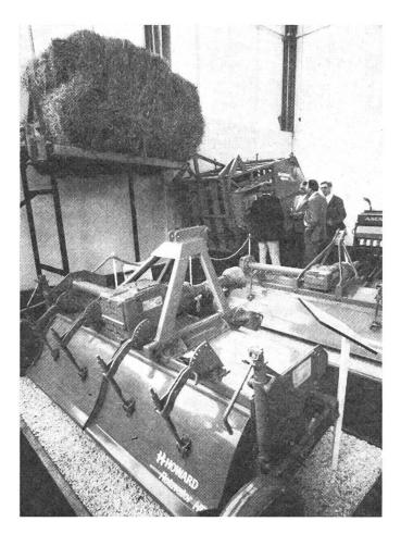
Eine neue Entwicklung in der Stroh- und Heuernte haben die hinten sichtbare Grossballenpresse und die Grossballen (1,5 x 1,5 x 2,40 m gross und etwa 500 kg schwer) eingeleitet; sie ermöglichen eine hohe Flächenleistung. (Fa. Howard-Rotavator)
