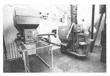
In der Schweinemast können diese beiden Futterautomaten (links: rollend auf einer Schiene im Futtergang; rechts: selbstfahrend) das Futter exakt dosiert in die Längs- oder Quertröge füllen. Bei dieser Fütterungstechnik hat sich der Quertrog, der gleichzeitig Buchtenwand ist, bewährt.
