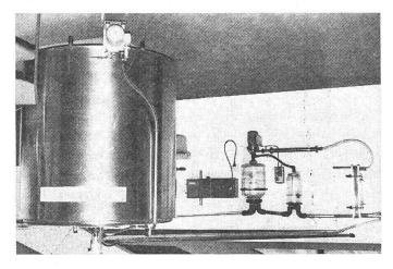
Man kann die Kühlkosten bei Milch senken, wenn man einen Gegenstrom-Durchflusskühler (links oben) einbaut, der die frisch gemolkene Milch auf etwa 14° C abkühlt; die Milchwärme wird an das vorbeiströmende Wasser abgegeben. Auf diese Weise kann man mehr Milch in dem grossen Kühlbehälter kühlen, weil die Milchmenge je Kühlfläche erhöht werden kann. Das verbilligt die Milchkühlung. (Fa. Lemmer-Fullwood)
