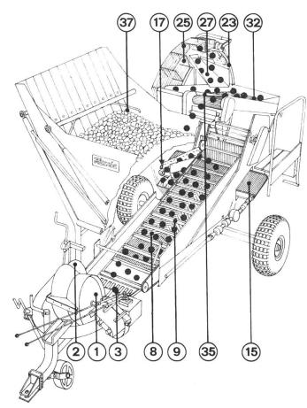
Abb. 6: Siebrost-Hubrad-Sammelroder.
