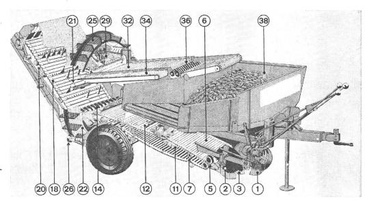
Abb. 2: Siebband-Hubrad-Sammelroder mit engmaschigem Krautband.
