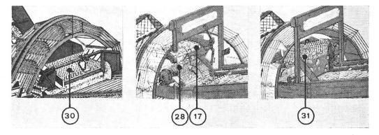
Abb. 4: Verschiedene Aggregate zur Stein- und Klutentrennung.
