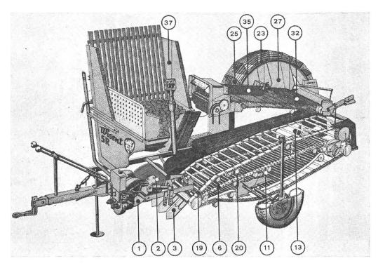
Abb. 3: Siebband-Hubrad-Sammelroder mit weitmaschigem Krautband.
