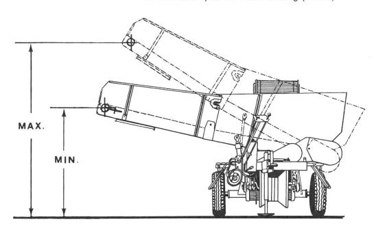
Abb. 7: Rollbodenbunker. Minimale und maximale Auslaufhöhe.
