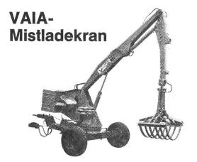
5-m-Auslegearm und Mistgabel, vollhydraulisch, Bereifung 10 x 15, mit grosser Hydraulik-Pumpe, an Zapfwelle oder mit Gelenkwelle, Diesel- oder Elektromotor. Jede Maschine kann auch mit Tieflöffel oder Greifer ausge-rüstet werden ab Fr. 8500.—
