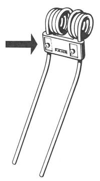
um einen flexiblen Kunststoffhalter, der am Zinkeneinlauf in die Federwindung montiert wird und so einen eventuellen abgebrochenen Zinken am Nebenzinken sicher festhält. Ein nachträglicher Anbau an bereits vorhandenen Maschinen ist ohne weiteres möglich. Die Zinken der Fahr-Kreiselheuer entsprechen der Norm von 200 000 Anschlägen auf dem Prüfstand. Das entspricht Millionen von Anschlägen in der Praxis.
