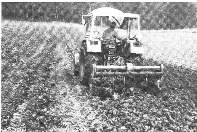
Abb. 7 +8: Spatenmaschinen mit Pendelspaten und Spatentrommel im Einsatz. Infolge relativ grobscholliger Struktur und nicht zugedeckten Pflanzenresten sind für die Saatbettherstellung am besten Geräte mit rotierenden Arbeitswerkzeugen, wie z. B. Spatenrolleggen und Scheibeneggen usw., zu verwenden.
