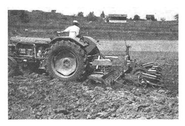
Abb. 10  $\pm$  11: Bei der Bestellsaat wird die Saatbett-Vorbereitung und Saat in einem Arbeitsgang durchgeführt. Für dieses Verfahren eignen sich die üblichen zapfwellengetriebenen Eggen und Sämaschinen bzw. -geräte, die direkt oder vermittels eines Spezial-Geräteträgers zusammengekuppelt werden (Abb. 11).
