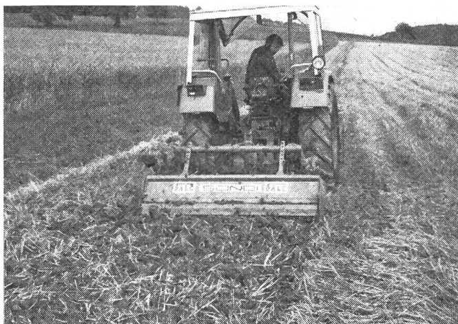
Abb. 7 +8: Spatenmaschinen mit Pendelspaten und Spatentrommel im Einsatz. Infolge relativ grobscholliger Struktur und nicht zugedeckten Pflanzenresten sind für die Saatbettherstellung am besten Geräte mit rotierenden Arbeitswerkzeugen, wie z. B. Spatenrolleggen und Scheibeneggen usw., zu verwenden.
