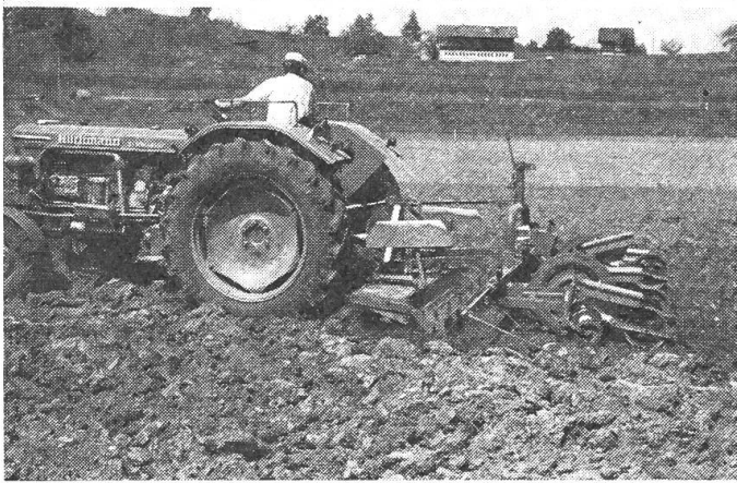
Abb. 10 + 11: Bei der Bestellsaat wird die Saatbett-Vorbereitung und Saat in einem Arbeitsgang durchgeführt. Für dieses Verfahren eignen sich die üblichen zapfwellengetriebenen Eggen und Sämaschinen bzw. -geräte, die direkt oder mittels eines Spezial-Geräteträgers zusammengekuppelt werden (Abb. 11).
