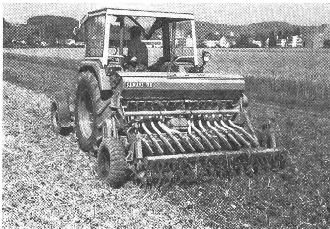
Abb. 9: Die Fräs-Saat kann mit gutem Erfolg für den Zwischenfutterbau und für den Weizenbau nach Hackfrüchten und Mais angewendet werden. In schweren Böden ist es angezeigt, den Acker zuerst ca. 20 cm tief zu lockern, und die Bildung einer Schmierfläche zu vermeiden.
