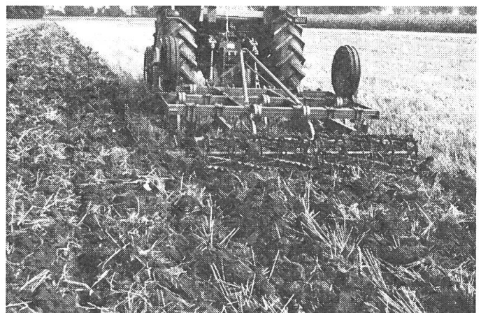
Abb. 6: Ein Krümler am Tiefgrubber ist für die Bearbeitung der grobscholligen Struktur zu wenig wirksam. Auf diese Ausrüstung kann in den meisten Fällen verzichtet werden.
