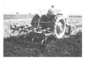
Abb.  $4\pm5$ : Für die Stoppel-Bearbeitung (Arbeitstiefe 15 bis 20 cm) sind alle Grubberarten und somit auch jene mit halbstarren Zinken geeignet.
