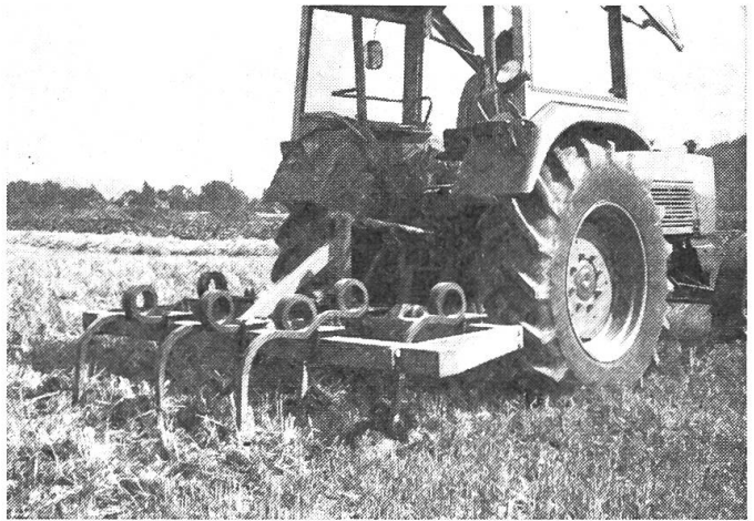
Abb. 1 + 2: Bei Grubbern mit gefederten Zinken entscheidet die Zinkendimension und -form über ihre Einsatzmöglichkeiten. Mit grossdimensionierten Vierkant- und Flachfederzinken lassen sich eine Bodenlockerung bis 25–30 cm und eine Stoppelbearbeitung gut durchführen.
