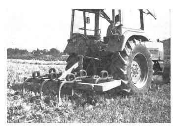
Abb. 1+2: Bei Grubbern mit gefederten Zinken entscheidet die Zinkendimension und -form über ihre Einsatzmöglichkeiten. Mit grossdimensionierten Vierkant- und Flachfederzinken lassen sich eine Bodenlockerung bis  $25-30\,$  cm und eine Stoppelbearbeitung gut durchführen.
