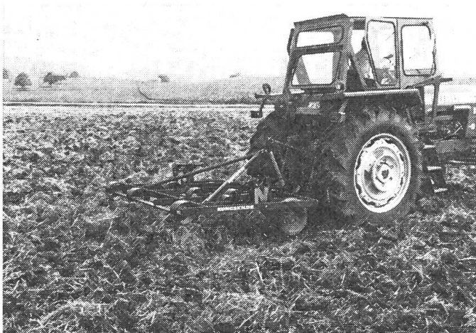
Abb. 4 + 5: Für die Stoppel-Bearbeitung (Arbeitstiefe 15 bis 20 cm) sind alle Grubberarten und somit auch jene mit halbstarren Zinken geeignet.
