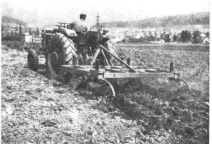
Abb. 1 + 2: Bei Grubbern mit gefederten Zinken entscheidet die Zinkendimension und -form über ihre Einsatzmöglichkeiten. Mit grossdimensionierten Vierkant- und Flachfederzinken lassen sich eine Bodenlockerung bis 25–30 cm und eine Stoppelbearbeitung gut durchführen.
