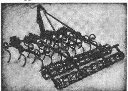
Gleiches Chassis auch für Tiefgrubber verwendbar. In Breiten von 2-3,3 m (auch Block-Chassis).
