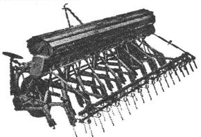
Breite 2–6 m, mit **Normal- oder Scheibenscharen,** beidseitiger Antrieb, Saatauslauf nach vorne, zentrale Druckregulierung usw.
