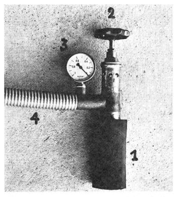
Abb. 2: Die «Illico»-Vacuumpumpe wird nach Entfernen des Luftfilters auf das Ansaugrohr des Dieselmotors montiert. Die Luftleistung erreicht bei Schnellleerlauf des Dieselmotors ca. 400 Liter. Die Montage ist nicht bei allen Traktoren problemlos.
