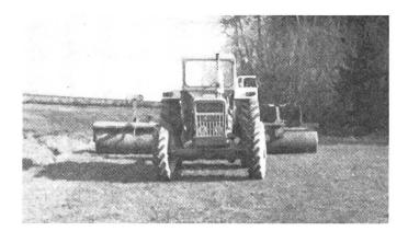
nere Rohre eingeschoben werden, die man aus- und einziehen und mit einem Stecknagel fixieren kann. Die andern beiden Walzen müssen überhaupt nicht verändert werden ausser einer einfachen Anhängevorrichtung hinten in der Mitte für die Strassenfahrt. Bei einer kürzlichen Reise durch die Tschechoslowakei sah ich ähnliche Konstruktionen mit 10–15 Walzen.
