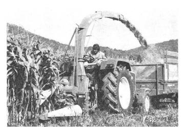
Schon vor Jahren brachte Pöttinger den zweireihigen Maishäcksler MEX 4 wahlweise als gezogenes Gerät oder für den Front- oder Heckanbau auf den Markt. In Kombination mit einer einfachen, an alle Traktoren passenden Rückfahreinrichtung, gelang es Pöttinger erstmals, mit einem preiswerten Anbauhäcksler die Arbeitstechnik und die Leistung eines teuren selbstfahrenden Häckslers zu erreichen.
