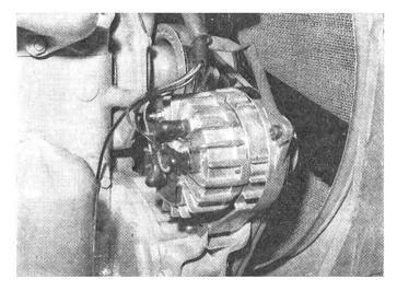
Geschlossener Drehstromgenerator mit Kühlrippen und Umlenklüfter, angebaut am Dieselmotor eines Traktors.
