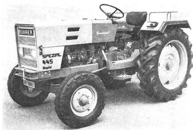
2250 kg an der Ackerschiene. Selbstverständlich ist dieser neue Traktor von Bührer mit verschiedenen Bereifungsvarianten und Wunschausrüstungen lieferbar, damit er genau den Bedürfnissen eines jeden Betriebes angepasst werden kann. Der BÜHRER 445 Spezial ist ebenfalls als Allradtraktor mit einem während der Fahrt zu- und abschaltbaren Vierradantrieb erhältlich.
