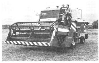
draulische Haspeldrehzahlverstellung vom Fahrersitz aus, Haspelhorizontalverstellung, Dreschtrommelantrieb über Variator mit nachgeschaltetem Zweiganggetriebe für besonders weiten Drehzahlbereich sowie hydrostatische Lenkung. Als Sonderausrüstung sind Langschneidvorrichtung, Trommel-Pick-up, Anbaustrohhäcksler, besonders breite Bereifung von 20–20 sowie eine staubdichte Vollkabine mit Belüftungs-
