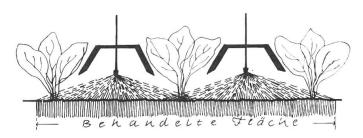
Schema einer Flächenspritzung mit einer Weitwinkeldüse (150° Weitwinkeldüse)
