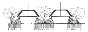
Schema einer Bandspritzung mit einer Düsenkombination (OC-Düsen)
