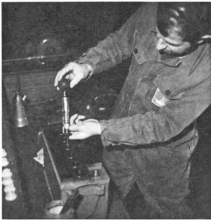
3. Luftfilter- und Auspuffverschluss entfernen.
