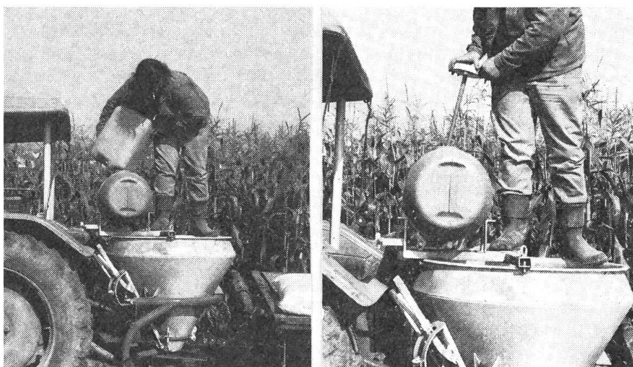
Abb. 6: Eine einmalige Behälterfüllung des Anfeuchtgerätes reicht für das Streuen von 15 bis 20 q Thomasmehl. Rechts Vorrichtung für die Aufrechterhaltung eines konstanten Wasserdruckes im Behälter.
