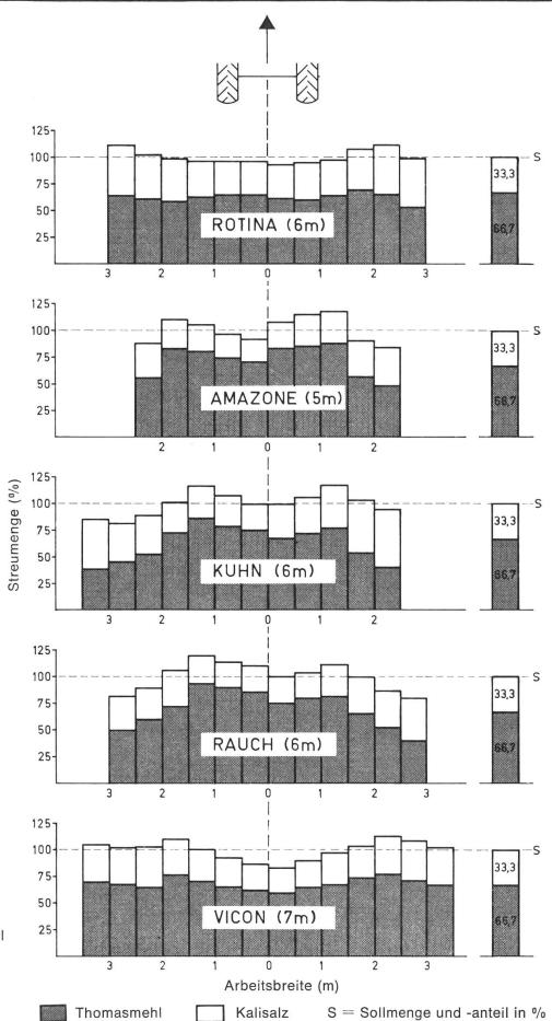
Abb. 4: Streugenauigkeit beim Ausbringen von Thomasmehl und Kalisalz im Gewichtsverhältnis 2:1 auf der effektiven Arbeitsbreite der einzelnen Streuer.
