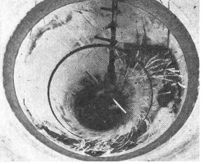
Abb. 3: Links Ansicht des Einscheibenstreuers Rotina mit Durchblick auf ein Stab-Zinkenrührwerk für pulverige Dünger. Rechts sichtbare Abnützung der Behälterwände durch angefeuchtetes Thomasmehl.
