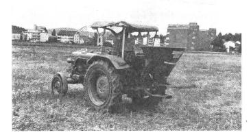
Abb. 7: Schleuderstreuer Rotina beim Ausbringen von Thomasmehl (Vergleichsmaschine).
