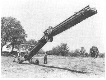
Dieses Ungetüm eines Endlosband-Laders (Kartoffeln) wird mittels elektronischer Fühler gesteuert. Die Steuerung bestimmt auch die geeignetsten Stellungen an beiden Enden des Fliessbandes.
