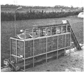
Die Anlage wird serienmässig in 3 Ausführungen geliefert: SBL 4 S; SBL D4 S und SBL D4 S doppelt B. Die Sortierleistung beträgt in der Stunde beim SBL 4 S 6000 kg, beim SBL D4 S und beim SBL D4 S doppelt B jeweils 12 000 kg.
