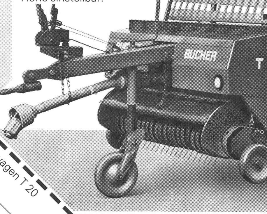
**4** Mit wenigen Handgriffen zum Universal-Transportwagen mit automatischer Entleerung umstellbar.
