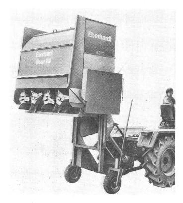
Siloaufnahmegerät im Traktor-Heckanbau...
