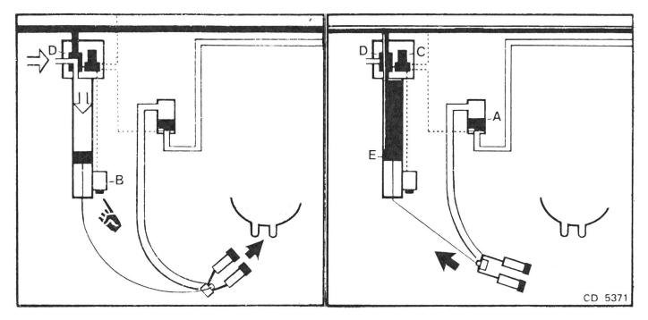
Abb. 6: Milchflussgesteuerte Melkzeugabnahme (C).
