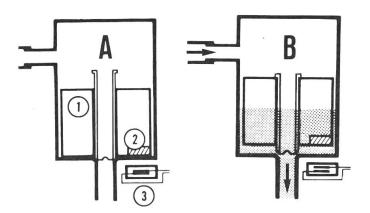
Abb. 2: Durchflussmesser mit Schwimmer und Magnetschalter.
