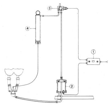
Abb. 1: Schema einer milchflussgesteuerten Melkzeugabnahme.
