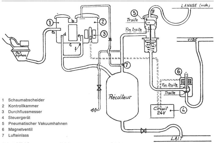
Abb. 5: Milchflussgesteuertes Abfallen des Melkzeuges (S.T.O.) B.
