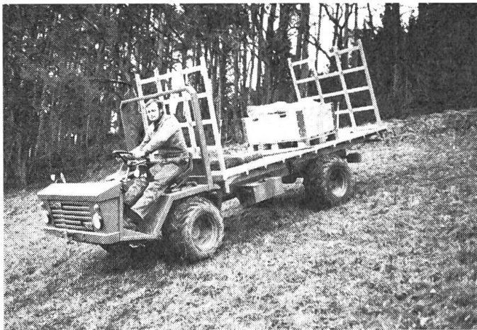
Abb. 4: Transporter, ausgerüstet mit Terrabereifung der Dimension 31 x 15,50 - 15.
