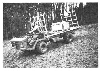
Abb. 4: Transporter, ausgerüstet mit Terrabereifung der Dimension 31 x 15,50 - 15.
