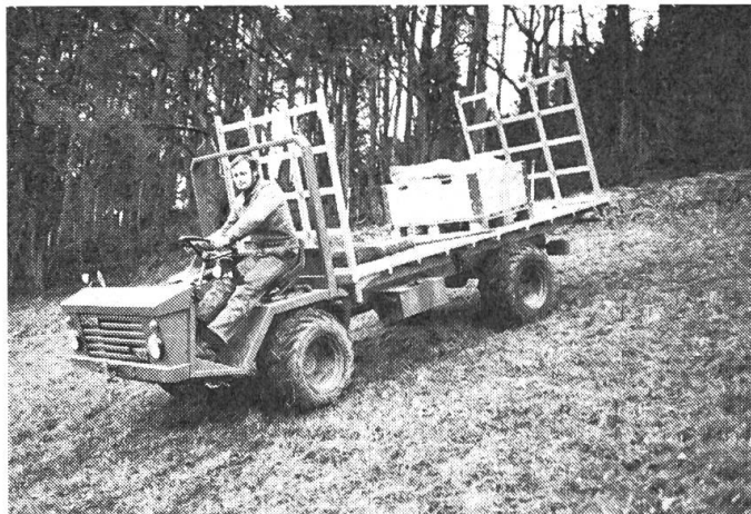
Abb. 4: Transporter, ausgerüstet mit Terrabereifung der Dimension 31 x 15,50 - 15.
