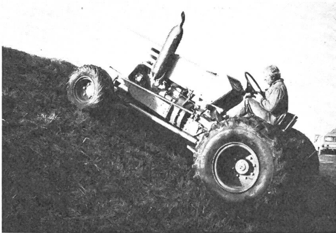
Abb. 1: Befahren einer Böschung (ca. 70% Neigung) in Falllinie.
