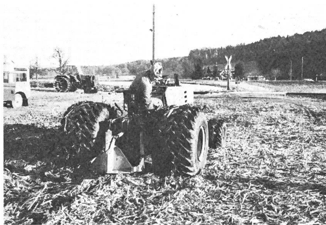
Abb. 3: Einsatz der Terrareifen mit Untergrund-Lockerer.
