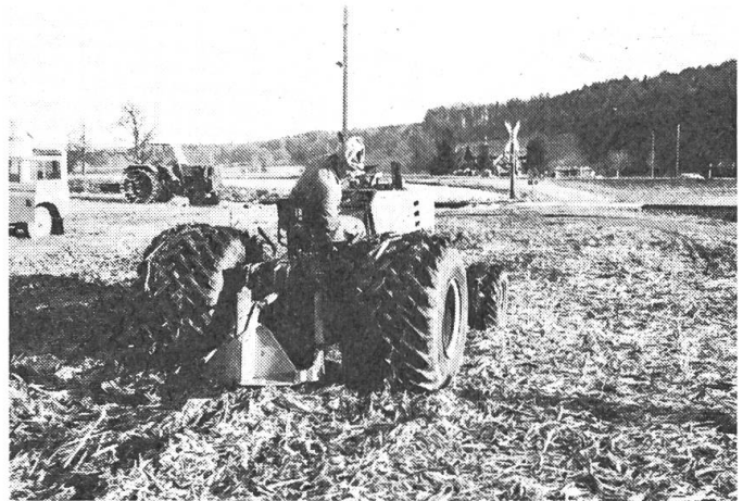
Abb. 3: Einsatz der Terrareifen mit Untergrund-Lockerer.
