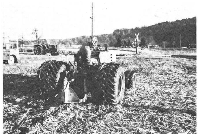
Abb. 3: Einsatz der Terrareifen mit Untergrund-Lockerer.
