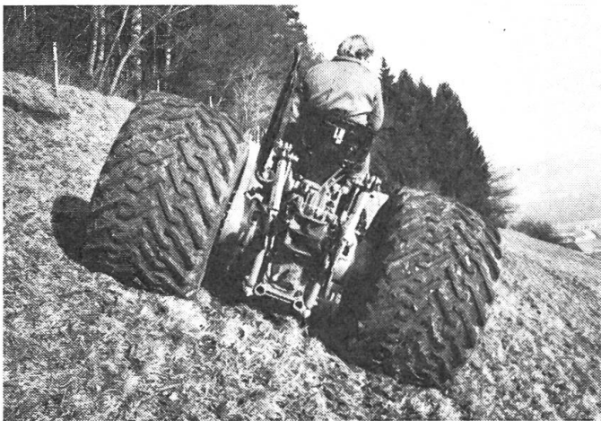
Abb. 2: Schonendes Befahren eines Hanges (ca. 50% Neigung) in Schichtenlinie.
