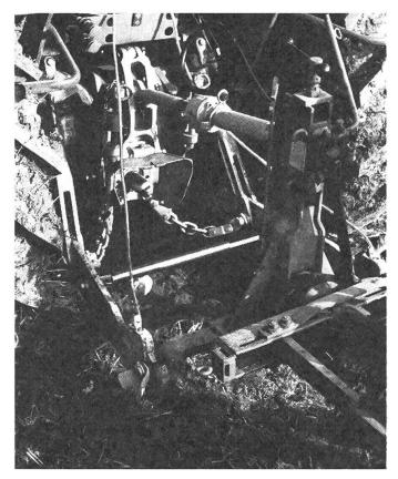
Abb. 1: Walterscheid-Dreipunktkuppler im Anbauzustand (Baustufe B).
