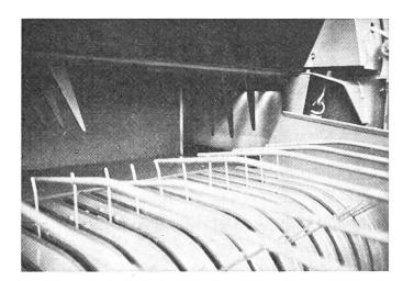
Abb. 1: Die Grösse der Einlassöffnung bestimmt die Pressenkapazität.
