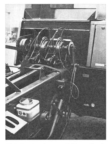
Abb. 2: Zentralschmierung am Knüpfer verkürzt die Wartungszeiten. (Bei diesem Fabrikat ist die Oelpumpe mit dem Nadelantrieb gekoppelt.)
