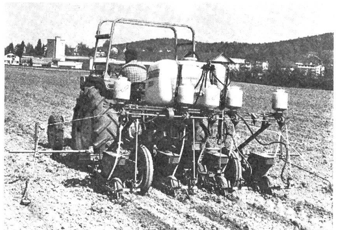
Abb. 1: Mais-Einzelkornsäat mit gleichzeitiger Herbizid-Bandspritzung und Ausbringung von Insektizid-Granulaten.
