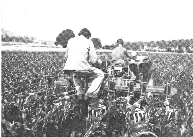
Abb. 3b): Hacksterne mit einstellbarem Federdruck und Gelenkführung.
