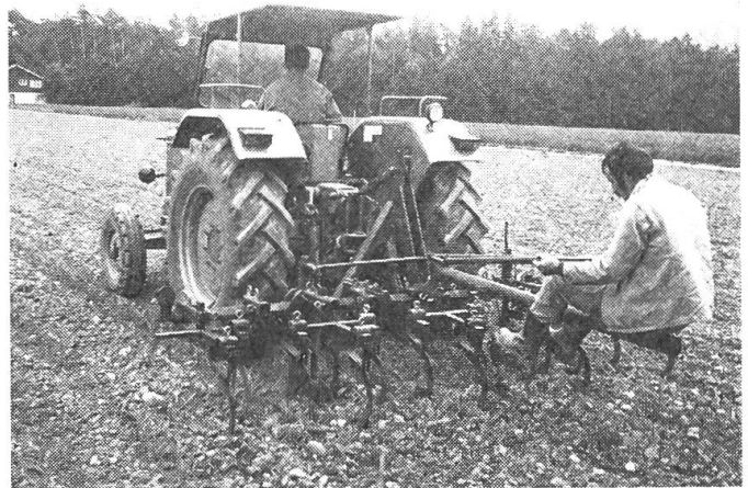
Abb. 2a): Konventionelles Vielfachgerät mit Gänsefusscharen.
